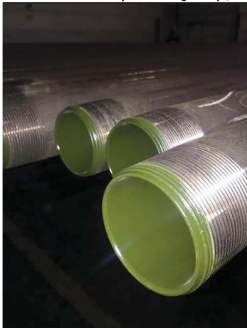
Покрытие на торцах НКТ
