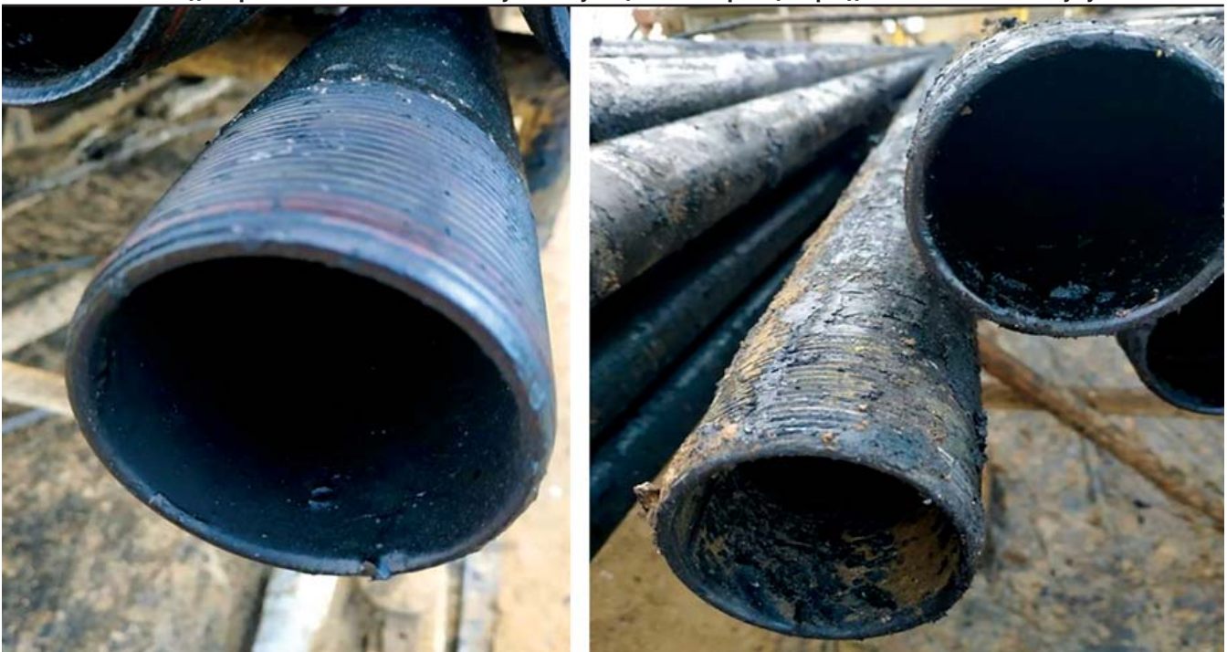
Рис. 7. Внешний вид покрытия ТС 3520А после 304 сут эксплуатации на истирающем фонде УШГН АО «Мангистаумунайгаз»
