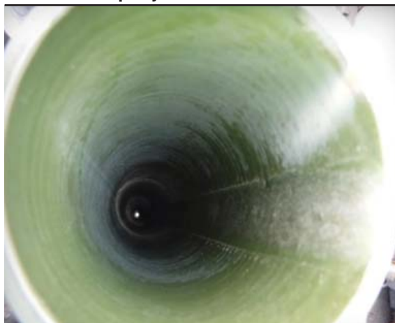
Рис. 9. Внешний вид покрытия Nilong TC 3000F после 734 сут эксплуатации на водозаборном фонде СП «Салым Петролеум»
