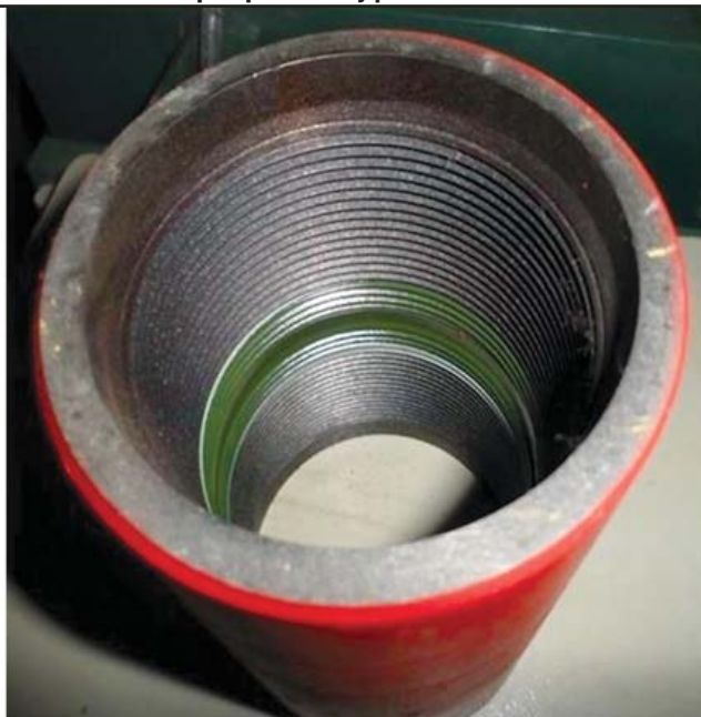
Покрытие межниппельного участка муфты
