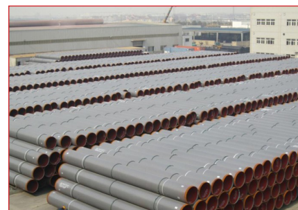
Рис. 2. Трубы с наружным порошковым покрытием для газопровода в Квинсленде (Австралия)
